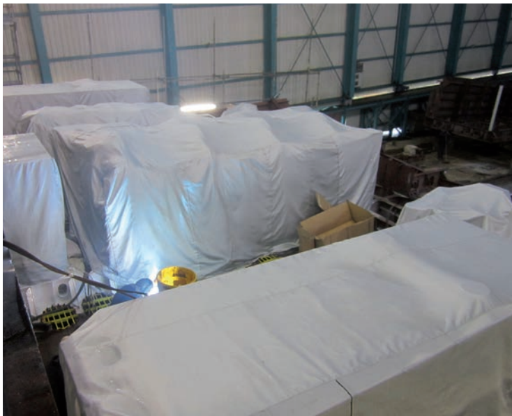
Enveloppes de groupes sur des chantiers navals pour des travaux de soudage
