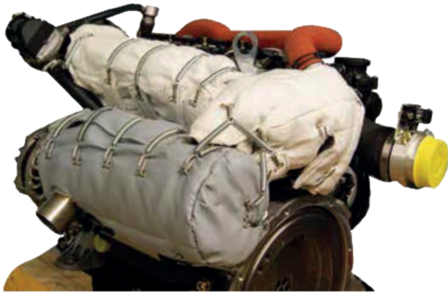
Kleiner Schiffsdiesel mit Isolierung für unterschiedliche Temperaturbereiche
